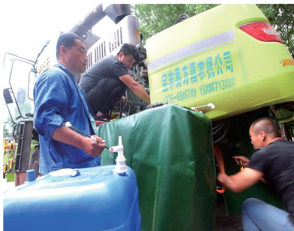
为减少小麦收割作业灰尘飞扬环境污染问题,实行环保机收,我县对今年参加三夏机收会战的600台小麦收割机免费安装降尘装置。图为5月24日,小麦联合收割机降尘安装技术人员在杨庄镇马街村为农机大户收割机安装降尘设备装置,助力三夏机收会战。王双正 摄影报道
