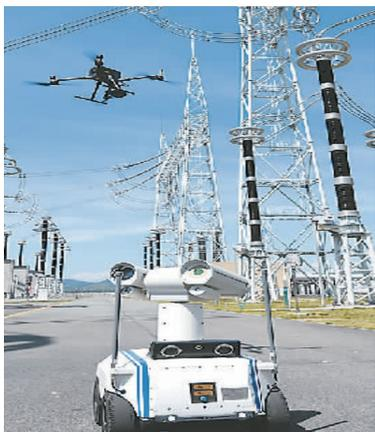
福建省福州市闽侯县大湖乡的1000千伏高压榕城变电站,采用了无人机和地面智能巡检机器人协同进行自主巡检。据介绍,无人机多机协同自主巡检攻克了变电站高精度三维建模、无人机巡检航线规划、复杂环境抗干扰等难题。(人民网)
