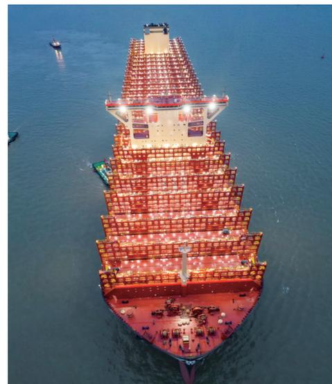
近日,全球最大新造集装箱船“鑫福103”轮在江苏太仓扬子三井船厂完成舾装,离泊前往舟山海域进行试航。“鑫福103”轮总长399.99米,型宽61.3米,龙骨以上最大高度78.1米,甲板面积达24000平方米,相当于3.3个标准足球场,最大堆箱层数可达25层,相当于22层楼的高度,一次可装载创纪录的24346个20英尺标准集装箱,是名副其实的海上“巨无霸”和“带货王”。
