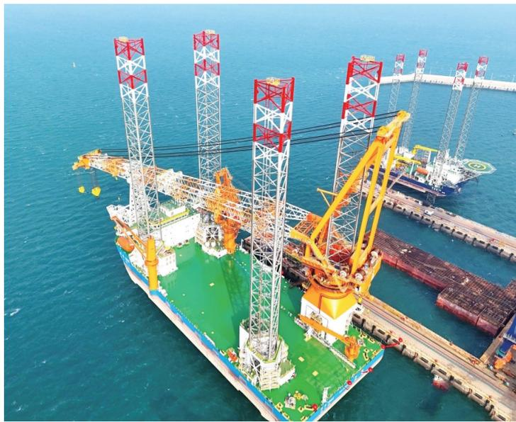
11月16日,航拍“华西1600”1600吨自航自升式风电安装平台,也是目前中国已交付同类型平台中桩腿长度最长、主吊机吊高最高、作业水深最大的风电安装平台。当天,该平台在山东青岛交付,这是中国自主设计研发、具有完全自主知识产权的新一代风
