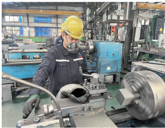
五星新材科技有限公司车间,工人正在打磨模具
