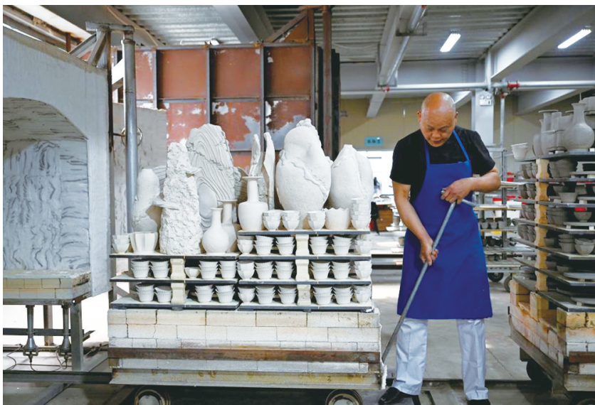
5月11日,在河南省宝丰县九道宝瓷车间,汝瓷艺人将装好的泥胎推进窑炉准备素烧。新华社记者 郝源 摄
